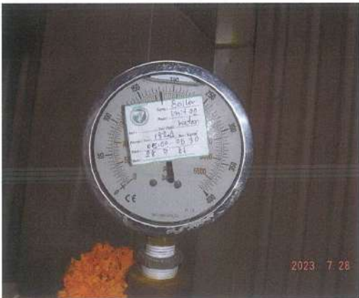
ภาพถ่ายแสดงแรงดันขณะทำการทดสอบ แรงดันในการตรวจสอบหม้อน้ำ
