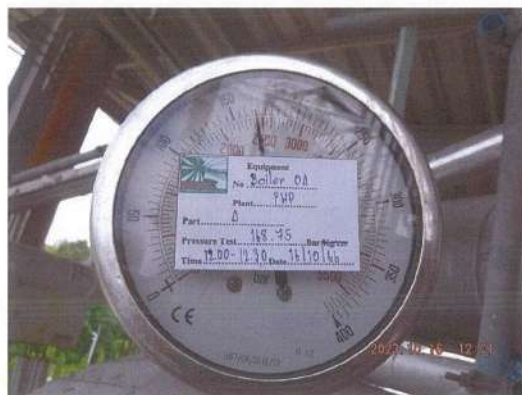
ภาพถ่ายแสดงแรงดันขณะทำการทดสอบแรงดันในการตรวจสอบหม้อน้ำ
